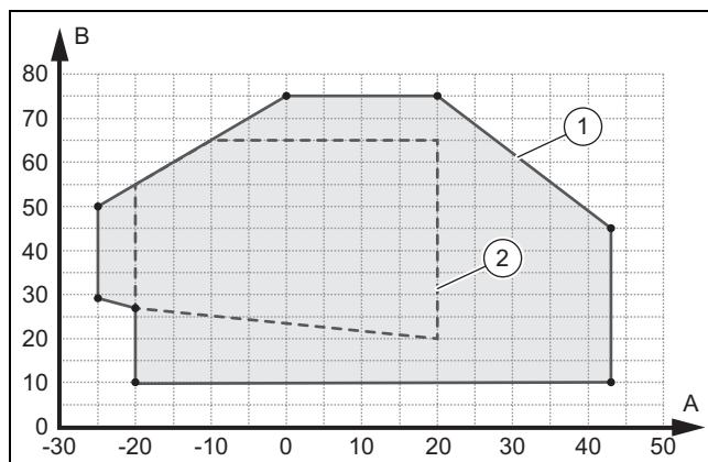
A Utomhustemperatur      1 Användningsgränser, värmedrift
