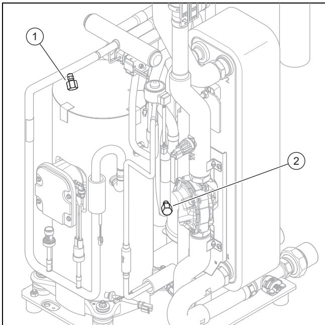
1. Tarkasta, onko rakenneosissa ja putkioksissa likaa ja korroosiota.
