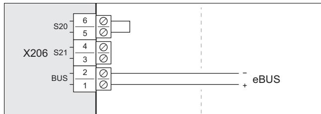
2. Tilslut eBUS-ledningen til tilslutning X206, BUS.
