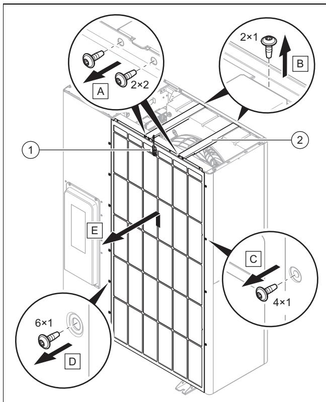
1. Irrota lämpötila-anturin (1) sähköliitäntä.
