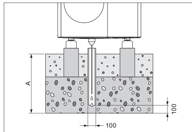
Mitta A on routa-alueella  $\geq 900$  mm ja roudattomalla alueella  $\geq 600$  mm.
