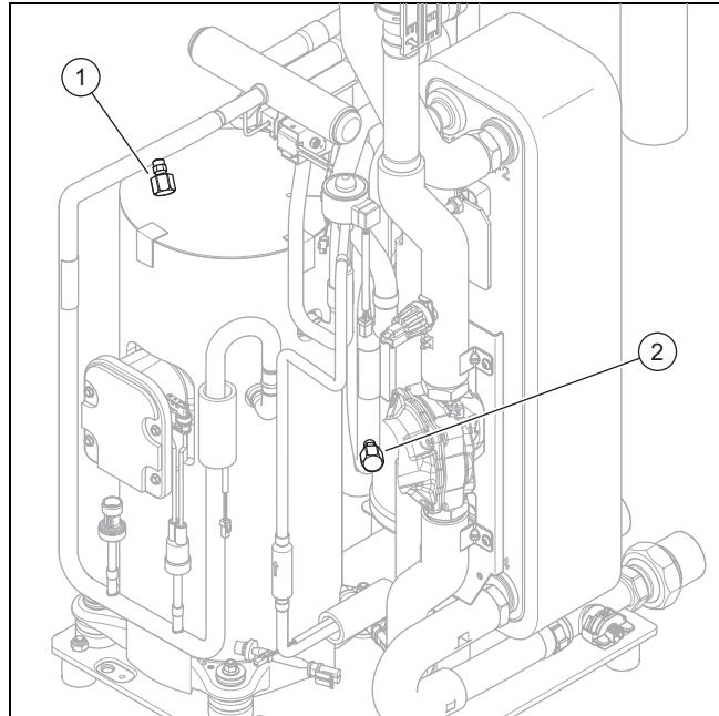
1. Kontroller at det ikke er urenheter og korrosjon på komponentene og rørledningene.
