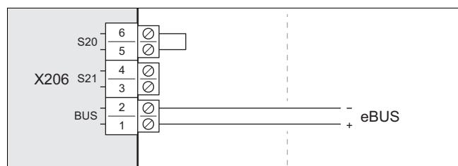
2. Koble til eBUS-ledningen på koblingen X206, BUS.
