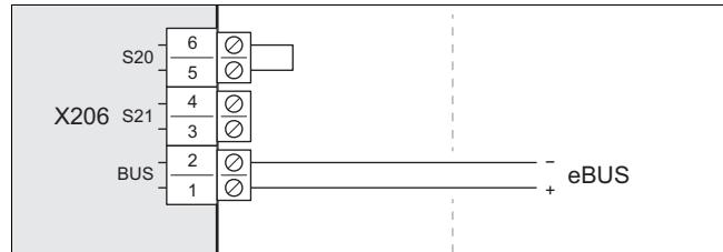
2. Anslut en eBUS-kabel på anslutningen X206, BUS.
