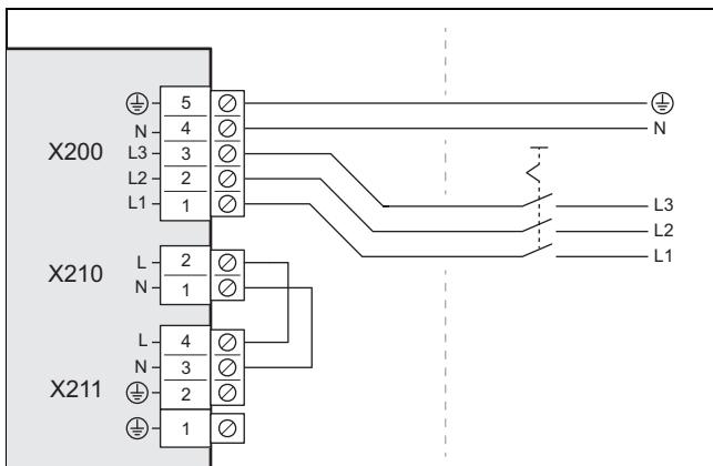
2. Installer en effektbryter for produktet i bygningen, som vist på bildet.
