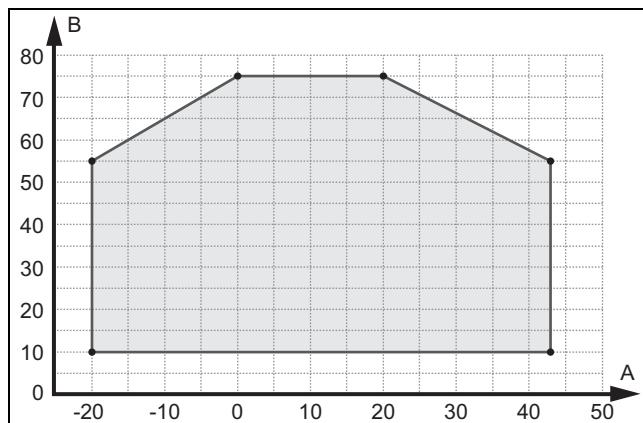
A Utomhustemperatur      B Värmevattentemperatur
