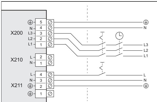
2. Installer en elektrisk effektbryter for produktet i bygningen, som vist på bildet.
